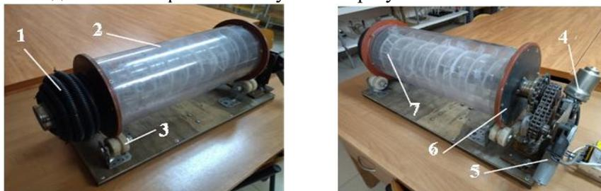
Рисунок 5 Стендовая установка для моделирования процесса агломерирования ТУ.
